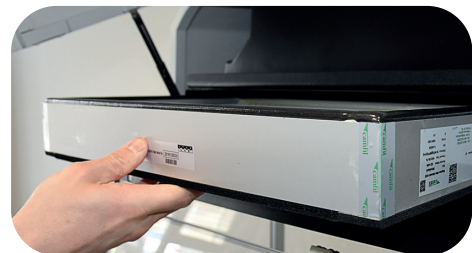
Fig. 49: Rimozione del filtro HEPA
