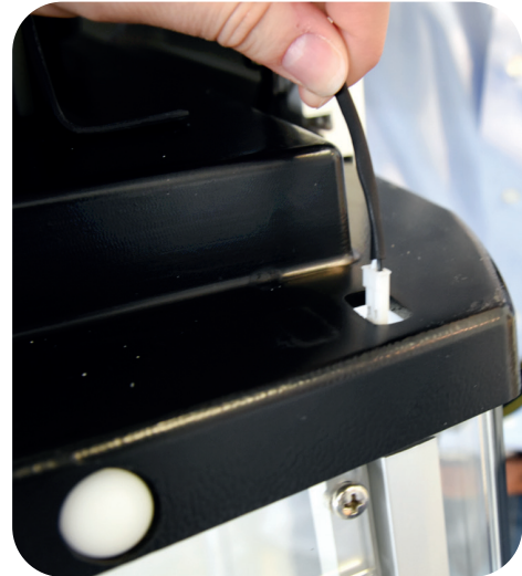
Abb. 16: Anschließen des Magnetsicherheitsschalters
