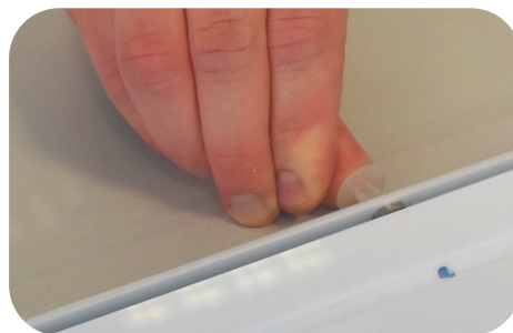
Fig. 5: Attacher le panneau arrière avec les rivets en plastique
