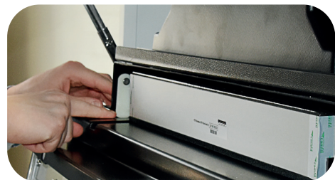
Fig. 48: Soulever le boîtier du filtre HEPA.
