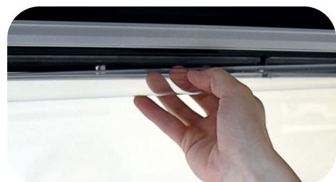
Abb. 51: Drehen der UV-Lampe
