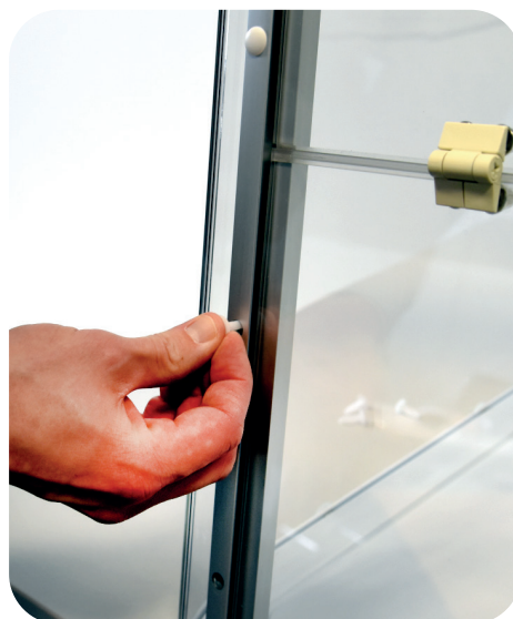
Fig. 10: Fissaggio dello sportello frontale con i rivetti in plastica
