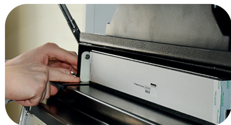
Abb. 48: Anheben des Gehäuses des HEPA-Filters
