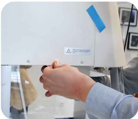
Abb. 14: Montieren des Gehäuseoberteils
