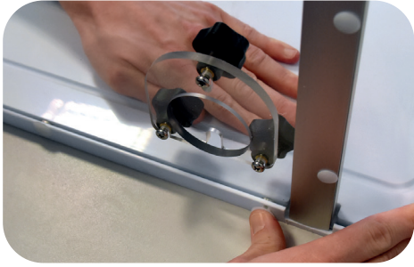
Abb. 7: Befestigen der rechten Seitenwand an der Bodenplatte
