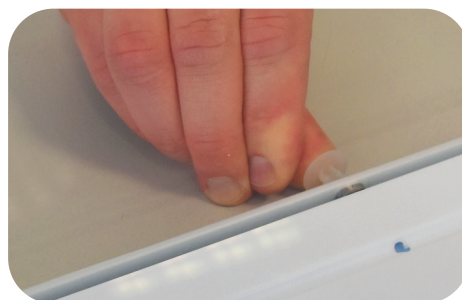
Fig. 5: Fissaggio del pannello posteriore con i rivetti in plastica
