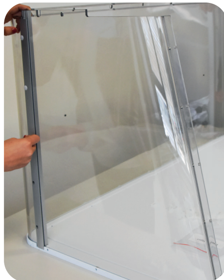
Abb. 6: Befestigen der PC-Rückwand mit Kunststoffnieten
