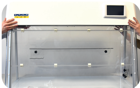
Fig. 12: Soulever le boîtier supérieur sur la chambre en verre du PC
