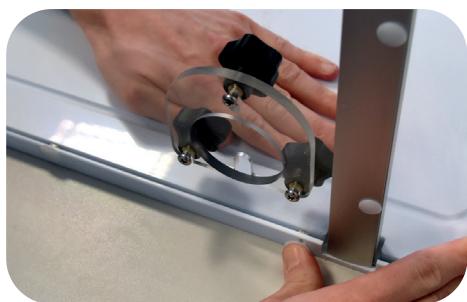
Fig. 7: Fissaggio del pannello laterale destro alla piastra di base
