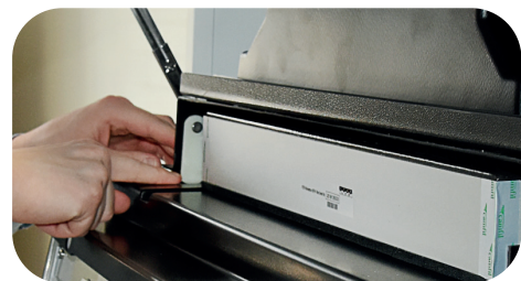
Fig. 48: Sollevamento dell'alloggiamento del filtro HEPA
