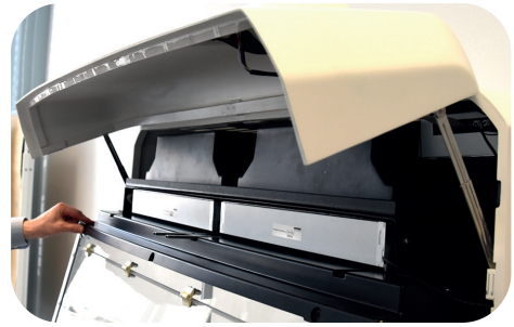
Fig. 15: Attacher le côté avant du boîtier supérieur
