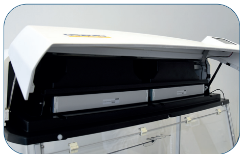
Fig. 53: Apertura della ribalta dell'alloggiamento superiore
