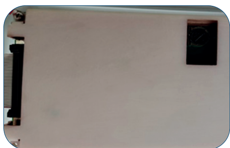
Fig. 54: Retro del touchscreen a cristalli liquidi con vano batteria
