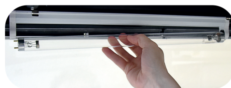
Fig. 17: Rotazione della lampada UV
