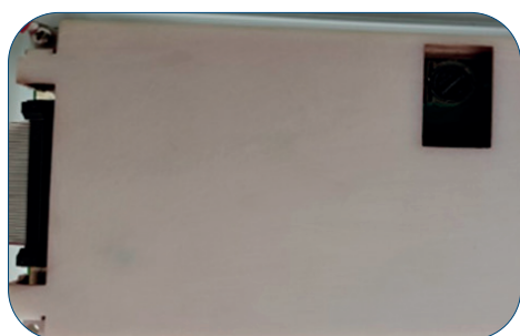
Fig. 54 : Arrière de l'écran tactile LCD avec ouverture pour la pile
