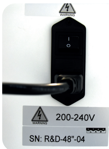
Fig. 18: Inserire il cavo elettrico nella relativa presa
