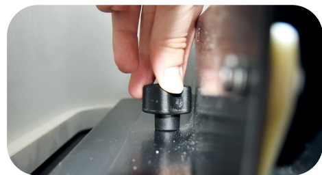
Abb. 47: Lösen der Schrauben (zwei bis drei Umdrehungen)
