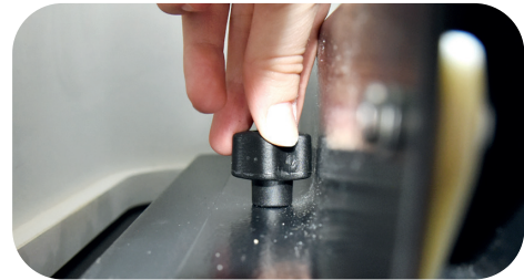
Fig. 47: Allentamento delle viti girandole due o tre volte
