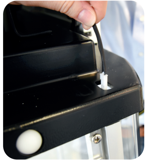
Fig. 16: Connexion de l'interrupteur de sécurité magnétique
