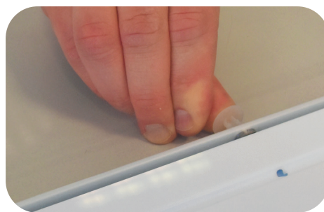
Abb. 5: Befestigen der Rückwand mit Kunststoffnieten
