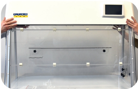
Abb. 12: Heben des Gehäuseoberteils auf die PC-Glaskammer
