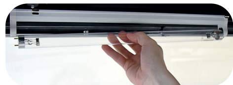
Abb. 17: Drehen der UV-Lampe
