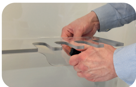
Fig. 8: Fissaggio del ripiano in PC sul pannello posteriore
