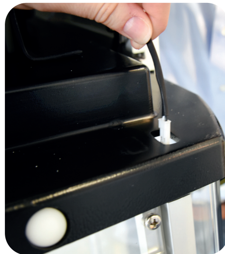
Fig. 16: Collegamento dell'interruttore magnetico di sicurezza
