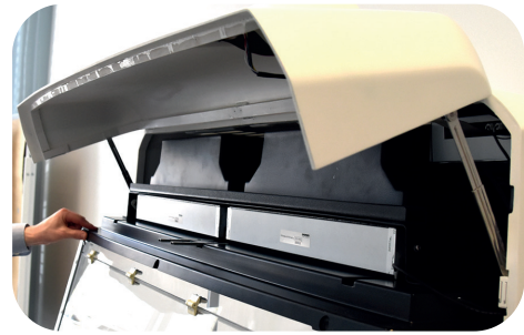
Abb. 15: Befestigen der Vorderseite des Gehäuseoberteils
