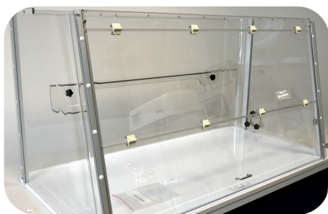
Fig. 11: Chambre en verre polycarbonate assemblée
