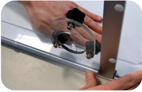
Fig. 7: Attacher le panneau latéral droit à la plaque de base
