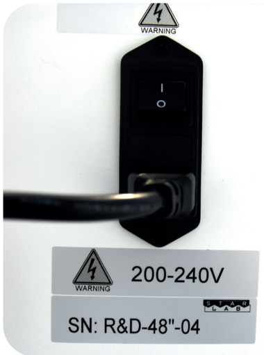
Fig. 18: Brancher le cordon d'alimentation dans la prise appropriée
