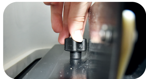
Fig. 47: Desserrer les vis de deux ou trois tours
