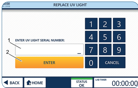
Fig. 24: Attivazione del monitoraggio automatico della durata utile della lampada UV
